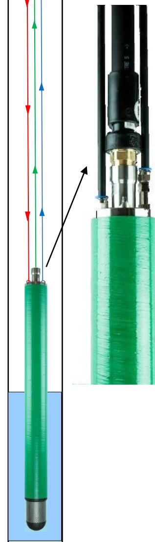
Las bombas neumáticas VP son fáciles de instalar y de remover. La salida de descarga se fija con un acople rosado en HDPE EF de 1 pulgada. De igual forma las líneas de entrada y salida de aire tienen 10 mm de diámetro con conexiones rápidas "push fit". Las bombas neumáticas VP pueden hacer parte de sistemas de bombeo multipozo, ya que no requieren medidores adicionales de nivel.
